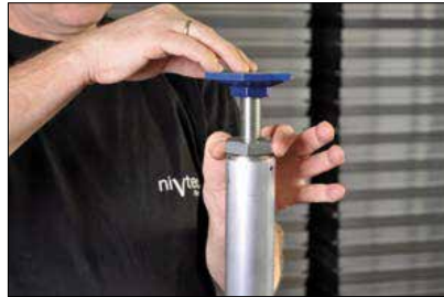
nivellieren Kontermutter festziehen
