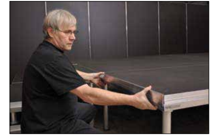
Verblendsleisten direkt einhängen
