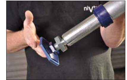
nivellieren Kontermutter festziehen
