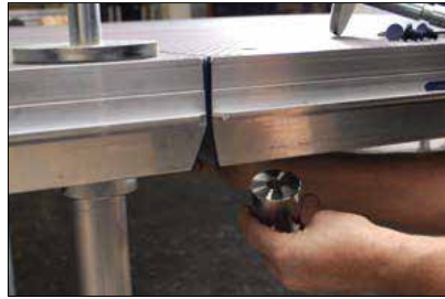
Detail: Adapter in Fußaufnahme einstecken und sichern
