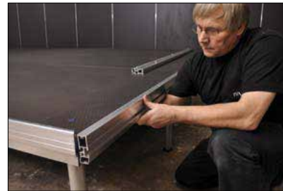
Federseiten: Adapterleiste aufsetzen und verriegeln
