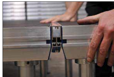
Adapterleiste einsetzen Alternativ: Treppenhochschwenker drehen (Nut hinten)
