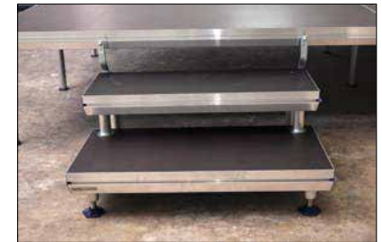
Verbindung von Treppe und Bühne (Nutseite): 1 Fuß-Verbinder 110 mm + 1 Verbinder N-F oder 2 Verbinder N-F
