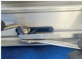
2. Schrauben und Muttern mittels Maulschlüssel lösen
