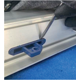
4. Gehäuse mittels Schraubendreher heraushebeln
