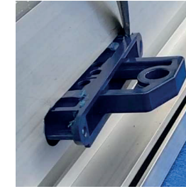
4. Gehäuse mittels Schraubendreher heraushebeln
