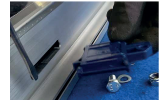
4. Gehäuse mittels Schraubendreher heraushebeln
