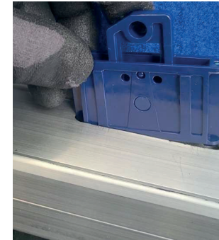
5. Neues Klick-Klack-Gehäuse in korrekter Position in das Langloch einschieben und mit einem Gummihammer im Wechsel links / rechts einschlagen.
